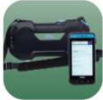
เครื่องวิเคราะห์ก๊าซในอากาศ มากกว่า 100 ชนิด
